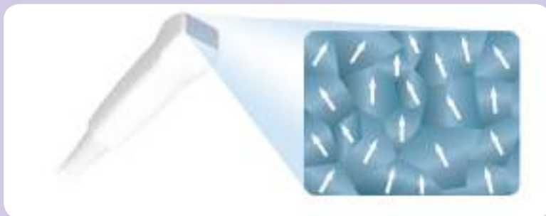
Tecnología PZT tradicional: las variaciones de polarización en PZT afectan sus propiedades piezoeléctricas y la relación señal/ruido (RSR)
